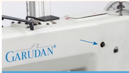
Délka stehu se nastavuje zatlačením ovládacího knoflíku a otočením ručního kola.
