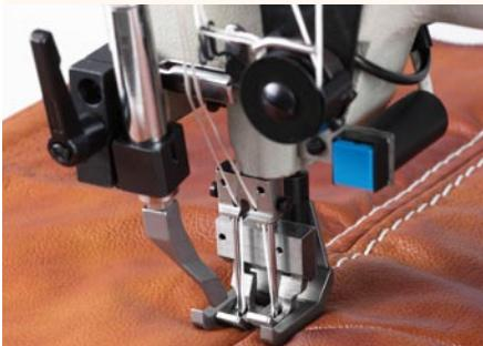
Provedení GF-14x-4411 a GF-24x-4411 jsou standardně dodávána s pneumatickým zdvihem patky a mikrozapátkováním. Na prání lze u dvoujehlových strojů dodat obostrannou kompenzační patku a pneumatický vodič pro rozešití ovládaný el. kolenní pákou.
